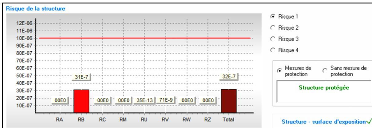
Le diagramme ci-dessus montre que la mise en œuvre d'un système de protection contre la foudre, de niveau IV minimum, abaisse le risque de perte de vie humaine R1 à une valeur égale à  $0,32 \cdot 10^{-5}$  ; valeur inférieure au risque tolérable RT fixée à  $10^{-5}$ .
